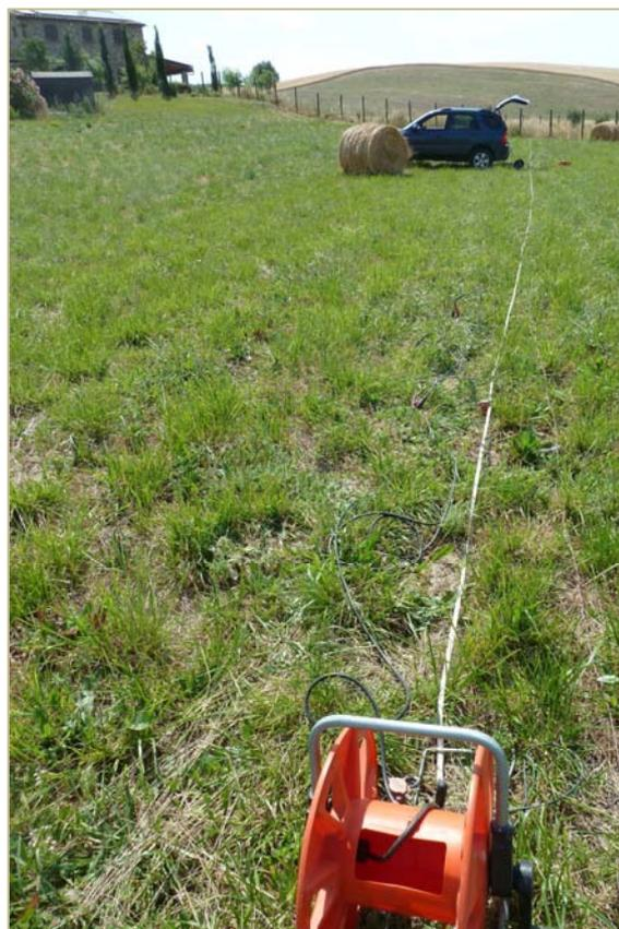
**Attrezzatura utilizzata:** Le indagini sono state condotte mediante l'utilizzo di un sismografo AMROGEO ECHO12-24/2002 a 24 canali.
